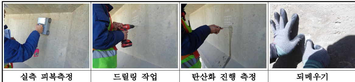
【그림 II-2.3.24】 탄산화 시험 측정 절차
