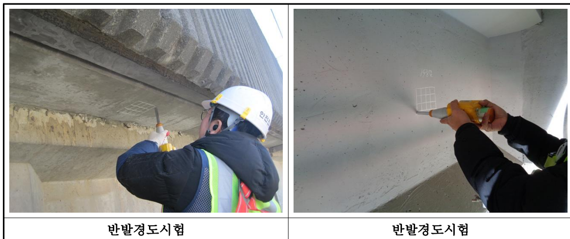
【그림 II-2.3.23】 반발경도 시험 전경
